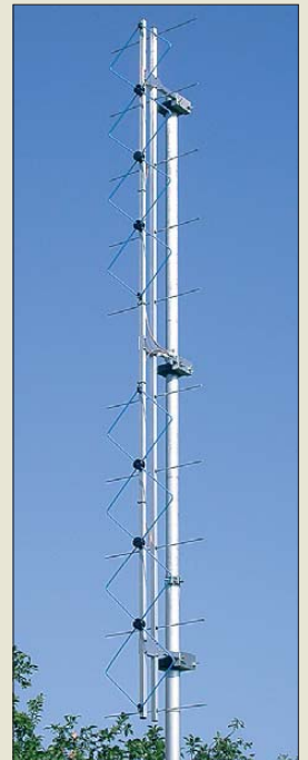
Die AQ70-000 in der nicht gestockten Grundausführung erzielt Öffnungswinkel von \alpha_H = 15^\circ (vertikal) und \alpha_E = 69^\circ (horizontal).
