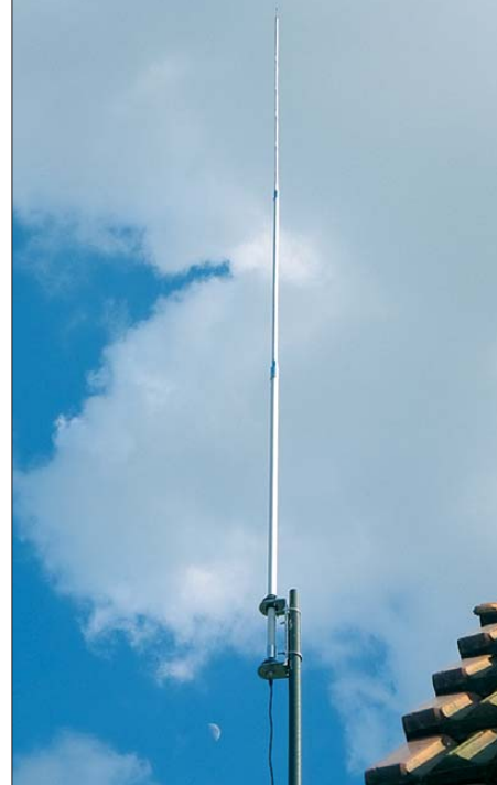
Bild 4: KFA-5000 auf 28,5 MHz abgeglichen
