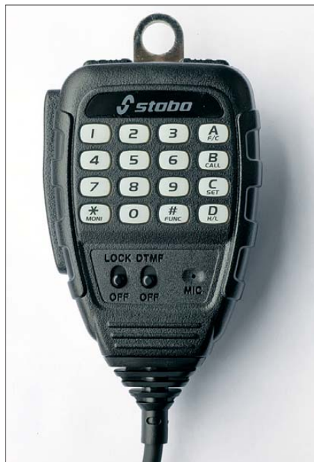
Bild 1: Alles unter Kontrolle: Wie bei einem professionellen Betriebsfunkgerät unterstützen die Elemente auf dem Handmikrofon eine komfortable Bedienung. Fotos: DL1ABJ
