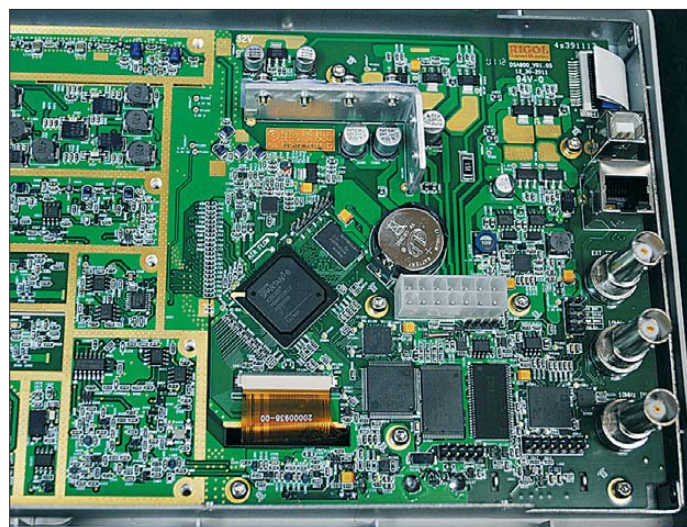
Bild 14: Leiterplatten-ausschnitt mit ZF- und Digitalteil des DSA815-TG
