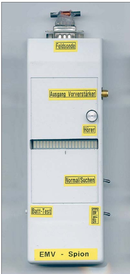
Bild 1: Labormuster des EMV-Spions mit aufgesteckter NF-Breitbandantenne
